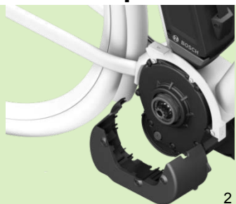
Samostatný ochranný kryt u Classic+ Line
